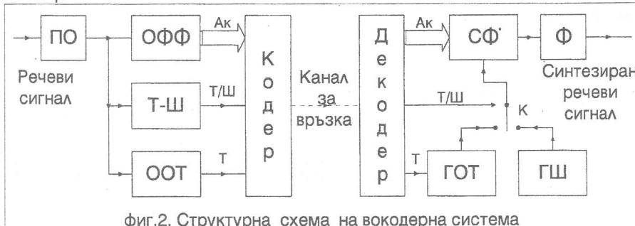
фиг.2. Структурна схема на вокодерна система
